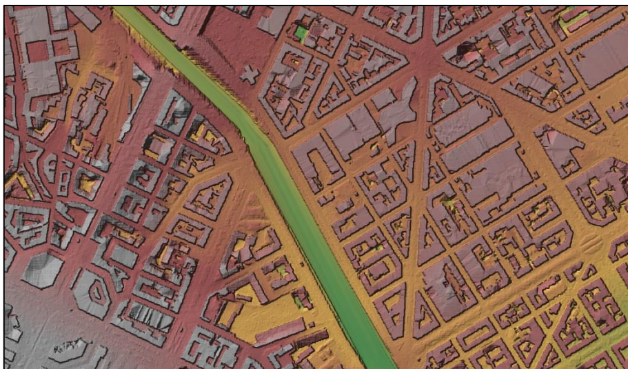
Figura 11 – Dettaglio del DSM ricostruito dagli scriventi che consente di simulare la presenza di edifici nell'area d'interesse, fortemente urbanizzata
