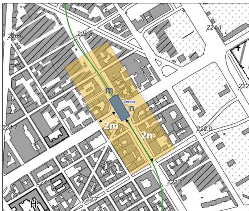
Figura 14. Estensione dell'area attorno al perimetro di una stazione (Verona) nella quale vengono definiti i parametri F , T , DF , I e Geo medi da utilizzare nei modelli numerici FEM-TH.
