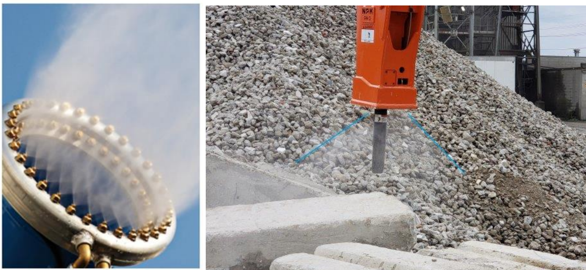
Figura 271. A sx: Cannone nebulizzatore; a dx: martello demolitore dotato di ugelli nebulizzatori
