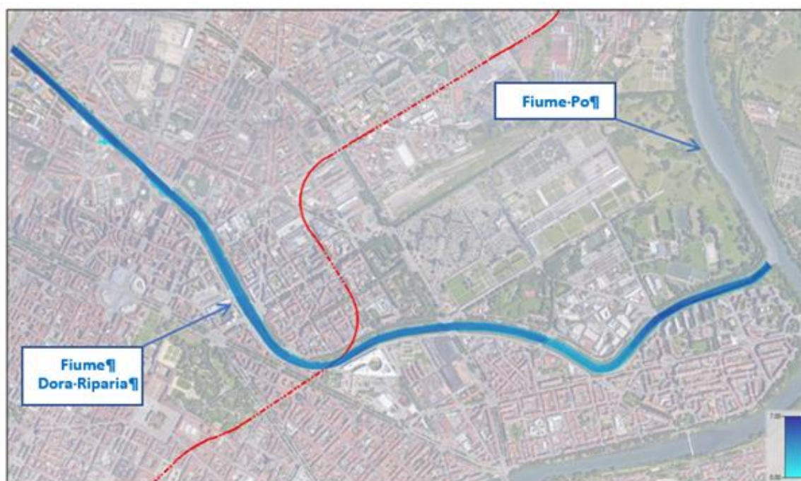
Figura 121. Massimi battenti in occasione di un evento di piena associato a un tempo di ritorno di 100 anni. La linea rossa rappresenta il tracciato della Metro 2
