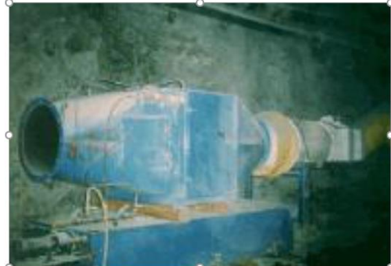
Figura 272. Mitigazioni ambientali (in senso orario): Spazzatrice stradale (Fonte: www.piquersa.es ); Impianto di lavaggio a pressione per pneumatici; esempio di filtro per polveri in galleria (Fonte: www.schauenburg-us.com ); Ugelli nebulizzatori in un impianto di frantumazione (Fonte: www.bgatech.it )
