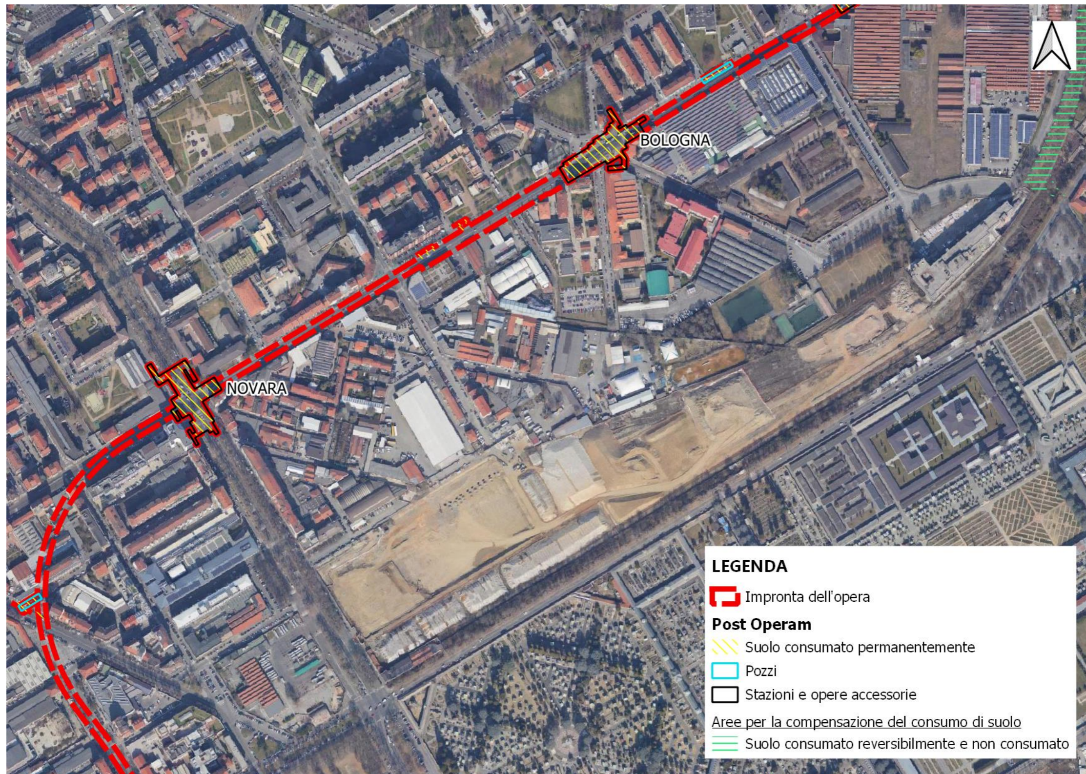
Figura 301. - Consumo di suolo - situazione di post operam - tratta Stazione Bologna – Pozzo Verona
