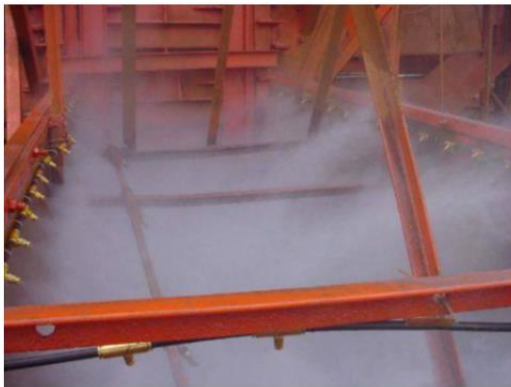
Figura 272. Mitigazioni ambientali (in senso orario): Spazzatrice stradale (Fonte: www.piquersa.es ); Impianto di lavaggio a pressione per pneumatici; esempio di filtro per polveri in galleria (Fonte: www.schauenburg-us.com ); Ugelli nebulizzatori in un impianto di frantumazione (Fonte: www.bgatech.it )
