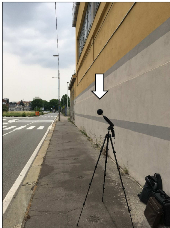
Figura 13 - Foto della Postazione di Misura P5 - Facciata Est dell'edificio prospiciente Corso Marche.
