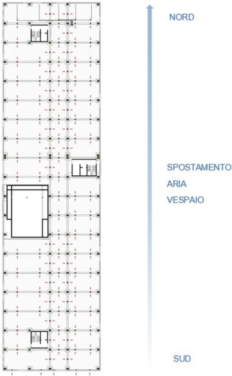
*Figura 18 – Direzione del deflusso di aria all'interno del vespaio aerato*
